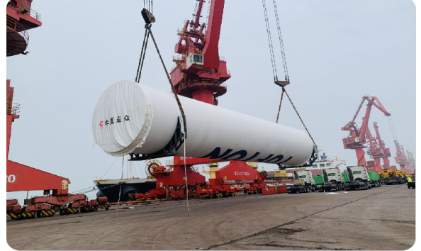
我国首支复合材料旋筒风帆开发成功并实现量产。
